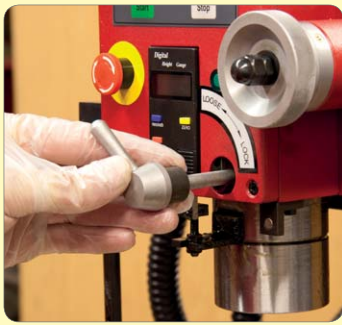
8. Remove the spindle locking bolt.
